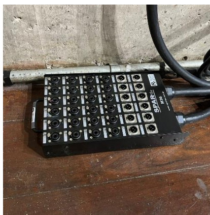
Via de 36 entradas
